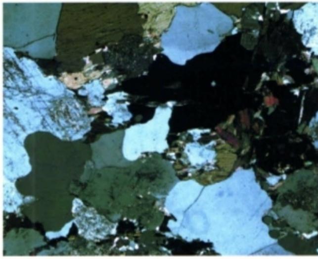
Текстура гранита массивная, однородная, трещиноватость не обнаружена.
